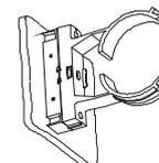
Промежуточную деталь откинуть и обе части закрепить 10 мм болтом. Монтаж до и после каждого шарового вентиля.
